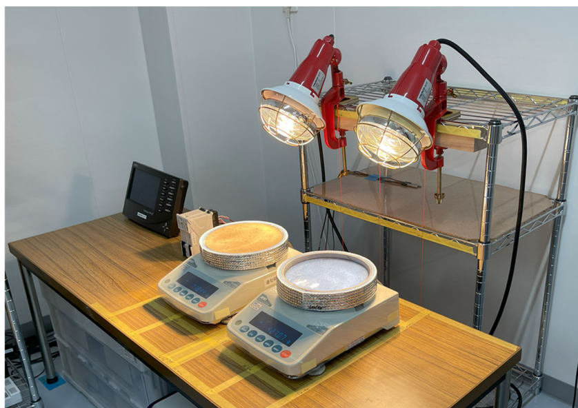
写真-3.2 投光器の設置状況
