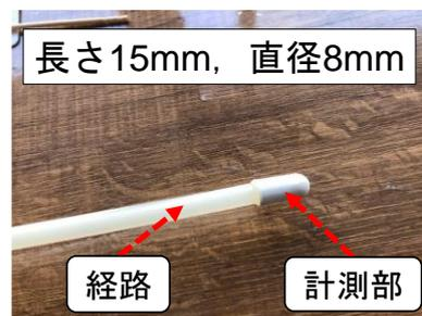
図 5.3.4 セラミック製ポラスカップ (CPC-1)
