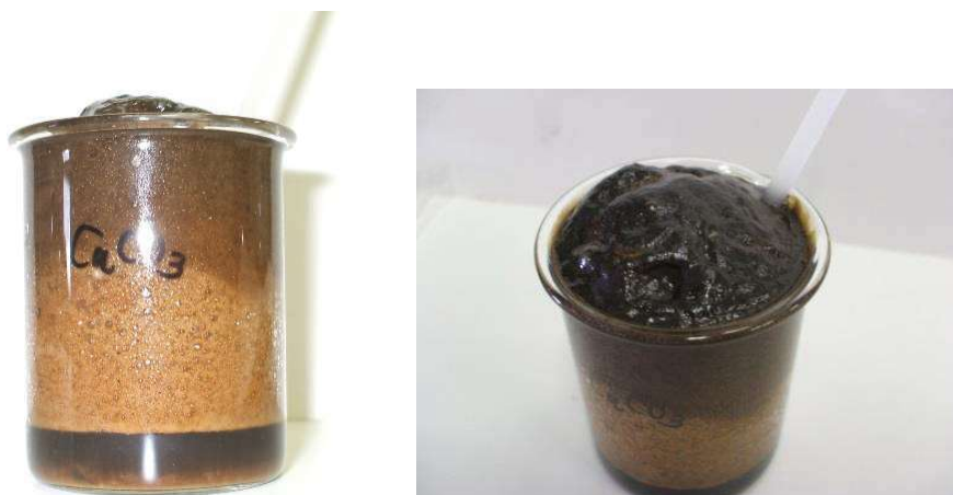
図 2-6 炭酸カルシウムおよび硫酸を添加した際の発泡の生成
