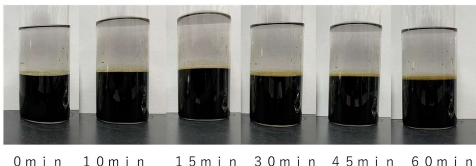
図 3-8 エタノールと希釈糖蜜を静置した際の経時変化観察結果
