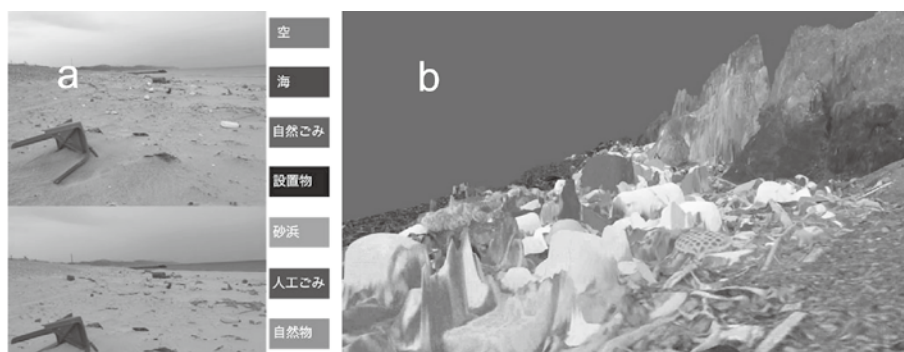
図 1. 開発したセグメンテーション手法とその応用例 (a) セグメンテーションモデルによる推定と分類クラス (b) ドローン測量による 3 次元モデルとセグメンテーションモデルによる推定結果の組み合わせで作成した海岸ごみの立体モデル
