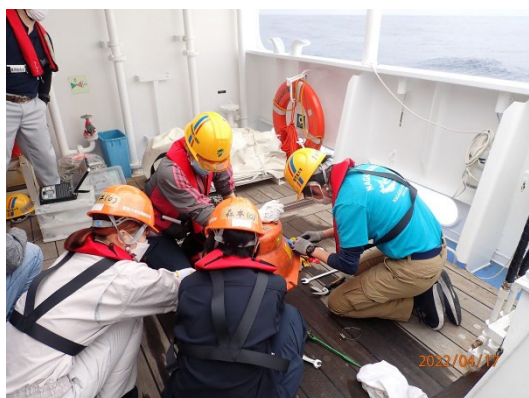
写真3 回収した海底地震計の外装解体
