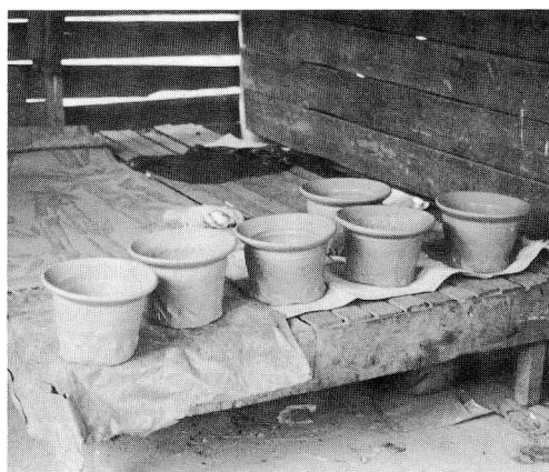
6. 上半部の成形後、乾燥させる。
