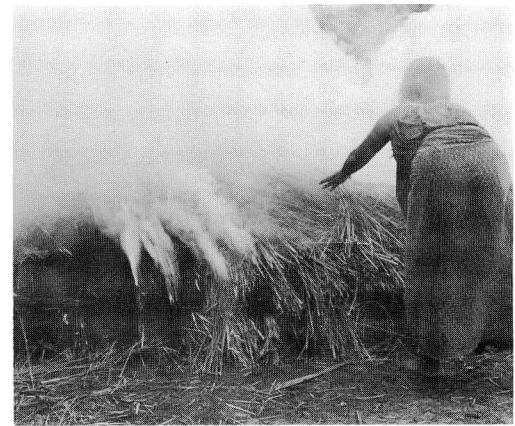
6. 床に火がついたら、ワラを上面に覆いかぶせて焼く。
