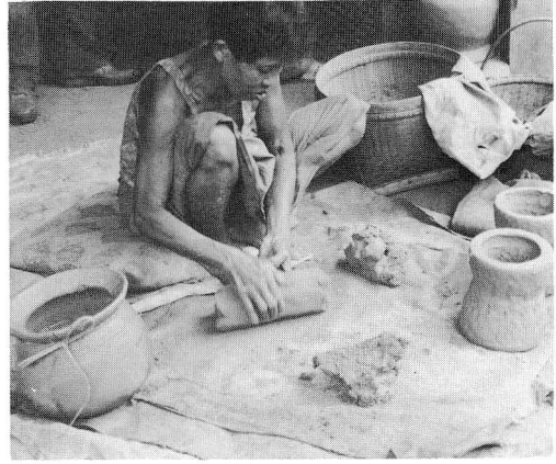
4. 粘土をこねて中空のツツミ状にする
