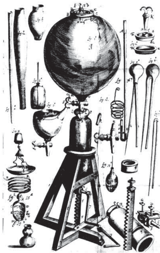
図8. ボイルの第1世代のポンプ ボイル『空気弾性論』より
