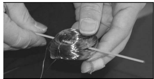
【図3 コイルと永久磁石で発電している様子】
