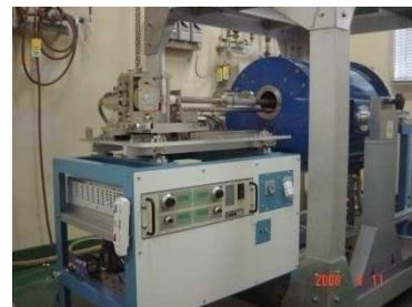
市販強磁場マグネットに組み込める世界初の小型X線粉末カメラシステム(トライ・エスイーとの共同開発)機能性材料の磁場中評価に利用(東北大設置)
