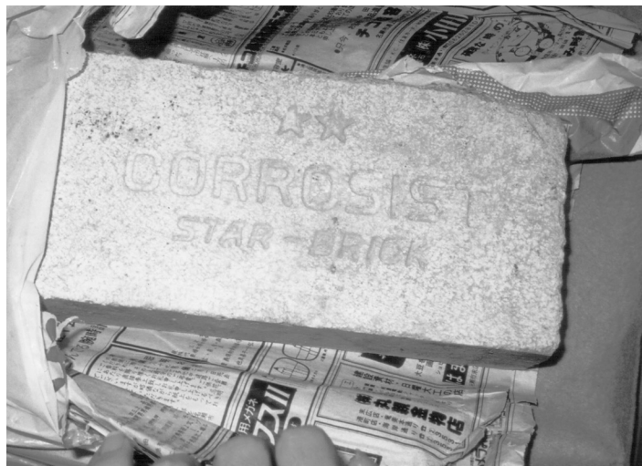
写真5 耐火煉瓦 (CORROSIST/STAR - BRCK)
