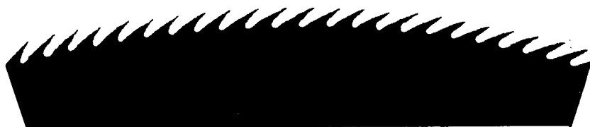
図7 鋸刃車の鋸刃の形状(原寸)
