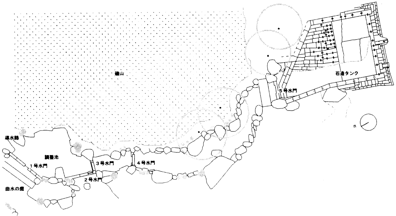
図-4 水力発電用石造タンク水路平面図
