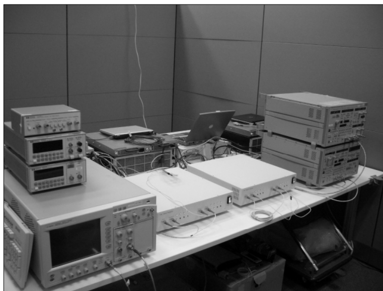
図 4.37 伝送実験用に試作した Y-00 光送受信端局の概観
