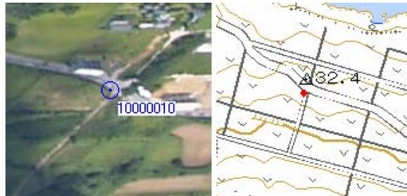
図-4.2 陸上における標定点の初期座標の取得の概念図(1/25,000 地形図より読定)
