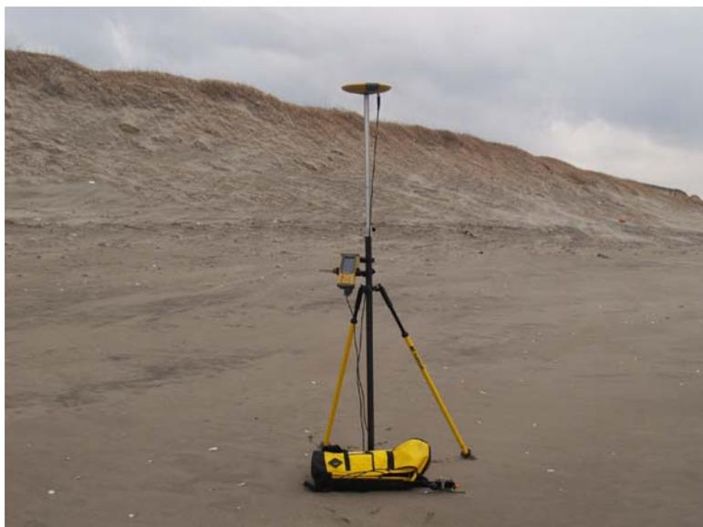
写真-2.2 VRS-GPS本体と測量現場
