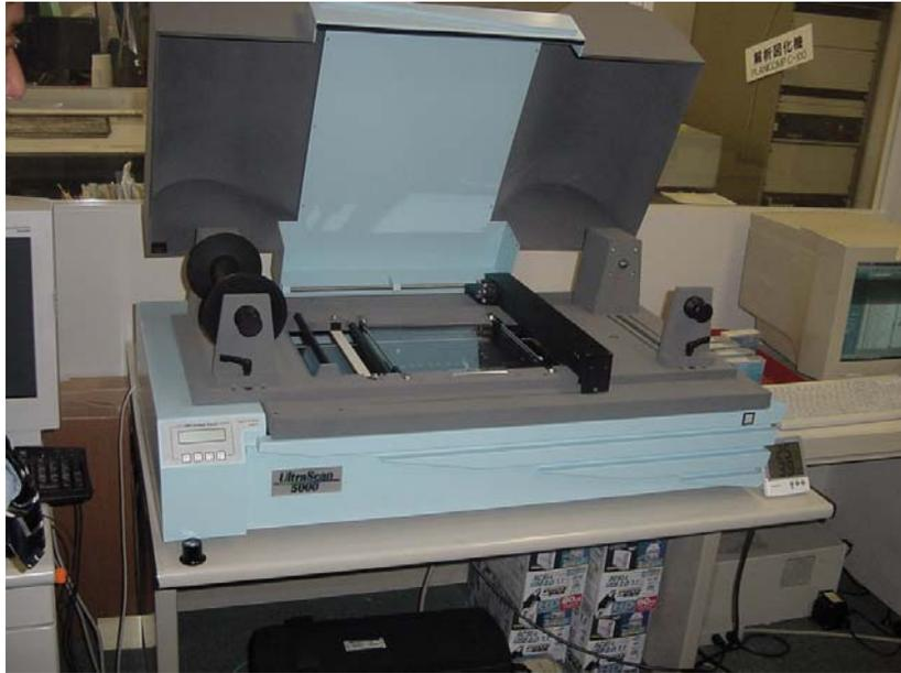
写真-3.2 写真測量用スキャナ
