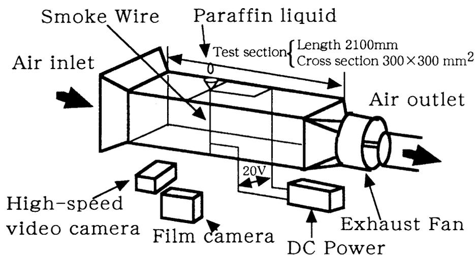
Fig.1. Experimental apparatus.
