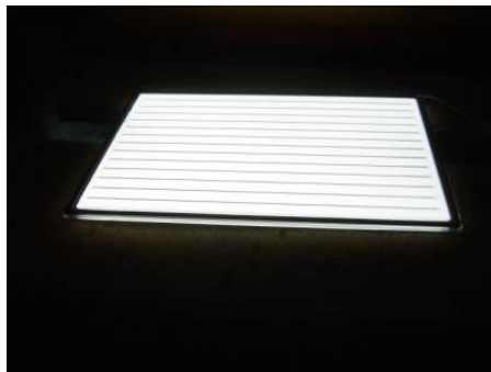
図 4.20 V_2O_5 -ZnO- TeO_2 系ガラスのシール用ガラスフリットを使用した平面 蛍光管の点灯状況及び封着結果
