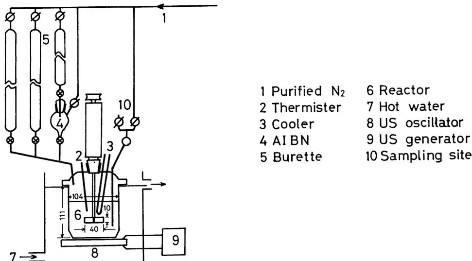
Fig. 1 Experimental apparatus
