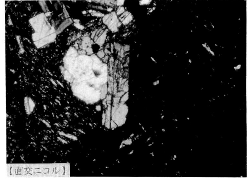
写真・3-1 アルカリ反応後の変化 (No. 2 骨材使用: \text{Na}_2\text{O} 等価量 2%)
