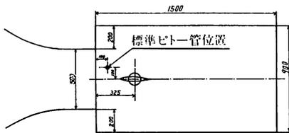
図2-1 実験装置側面図
