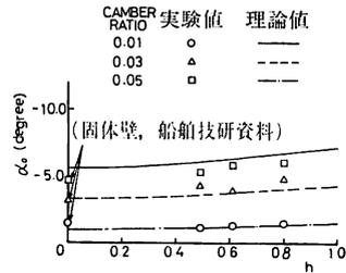
図22-2 零揚力角 (THICKNESS RATIO 0.07)
