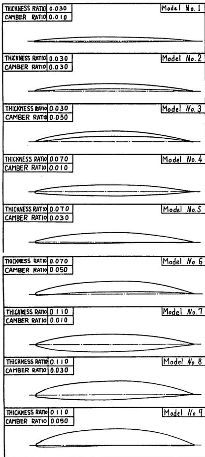
図6 翼型模型断面図
