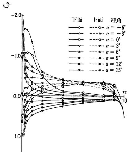
図12-2 Model No. 5 の圧力分布 (吹口幅 400mm)
