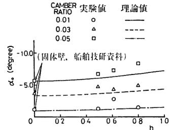
図22-3 零揚力角 (THICKNESS RATIO 0.11)
