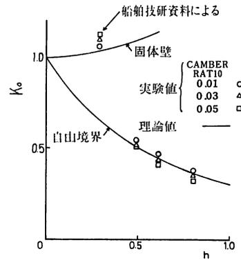
図21-2 揚力の干渉係数 (THICKNESS RATIO 0.07)
