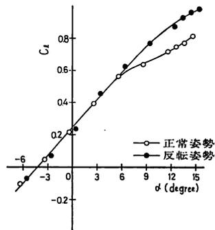
図11-1 Model No. 5 の揚力係数 (吹口幅500mm)
