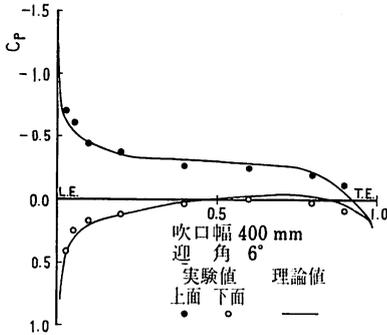
図24 翼表面圧力分布の実験と理論の比較 (Model No. 4)
