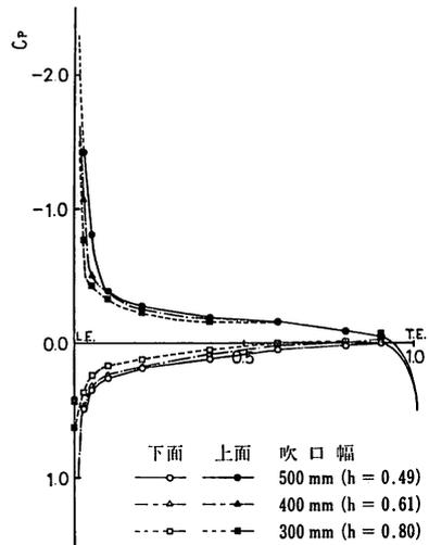
図12-1 Model No. 1 の圧力分布 ( $\alpha=6^\circ$ )
