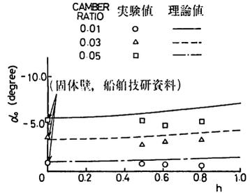
図22-1 零揚力角 (THICKNESS RATIO 0.03)
