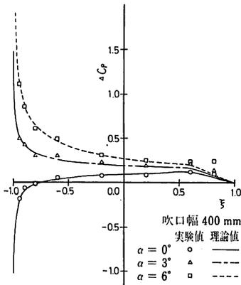
図23-1 循環密度の実験と理論の比較 (Model No. 4)
