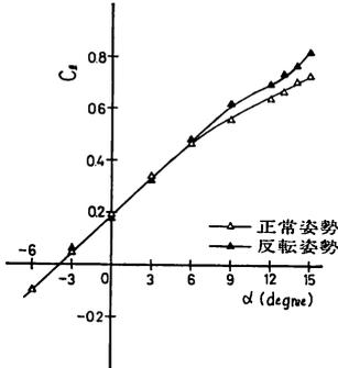
図11-2 Model No. 5 の揚力係数 (吹口幅 400mm)
