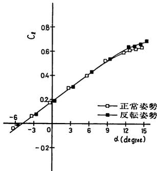
図11-3 Model No. 5 の揚力係数 (吹口幅 300mm)
