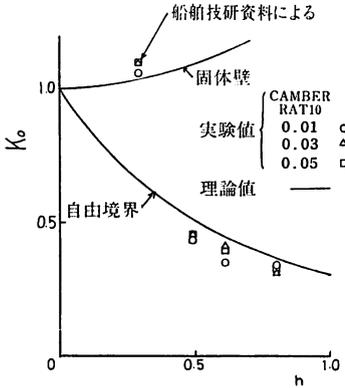
図21-3 揚力の干渉係数 (THICKNESS RATIO 0.11)
