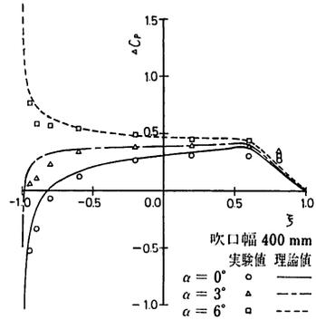
図23-2 循環密度の実験と理論の比較 (Model No. 5)
