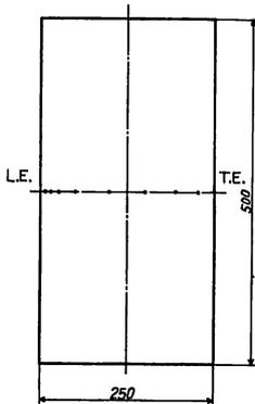
図5 翼型模型平面図
