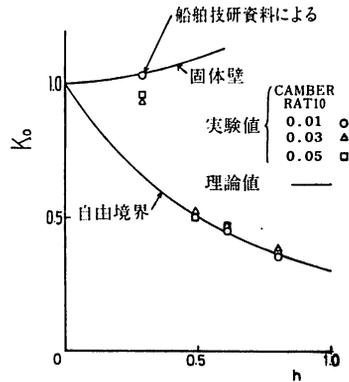
図21-1 揚力の干渉係数 (THICKNESS RATIO 0.03)
