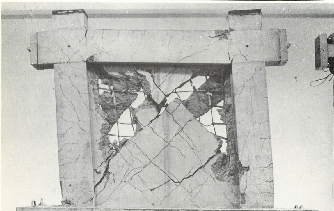
写真3 (b) 最終時 (SRC 試験体)
