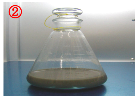
② 底質試料と滅菌した純水 100ml を混合し懸濁液を作る
