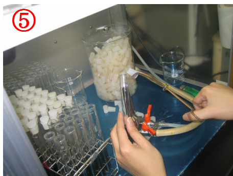
⑤ 試験管の口とシリコン栓を火炎滅菌して栓をする
