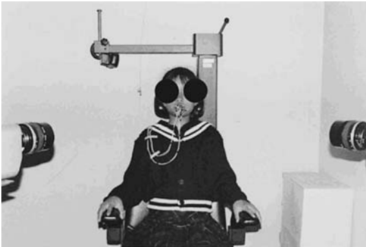
図1 セルスポットを応用した下顎多点運動解析システムと計測風景
