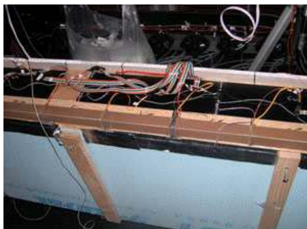
図 3.2-11 釘打ちフィン部、枠見込面、窓台見込み面の熱流計
