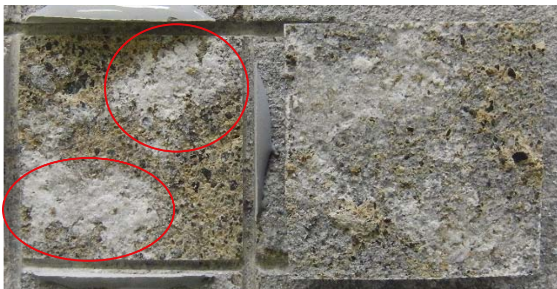
写真-4.2.2 溶射金属皮膜の膨れた箇所の付着試験（海洋環境）
