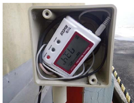
写真-5.2.4 デ湿度計設置状況
