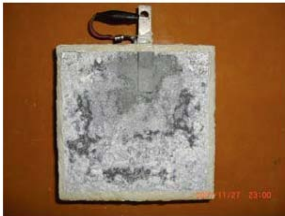
（「Z」 40℃乾湿繰り返し：白い変色部分が溶射膜の浮き）
