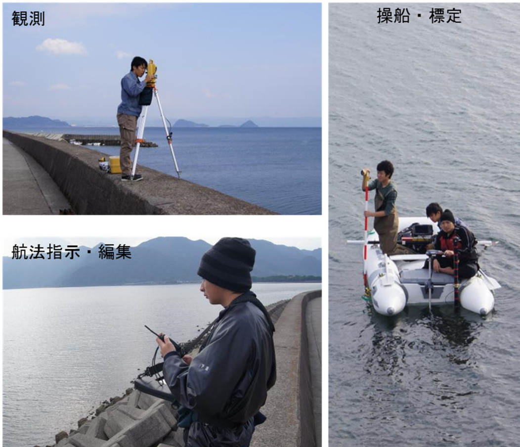
図 2-4 海浜測量における地形測量実施の様子。護岸に設置された基準点より TS と電子平板を用いて干潟の標高点を取得。深淺測量も同様にインフレーターボートを使用して観測。
