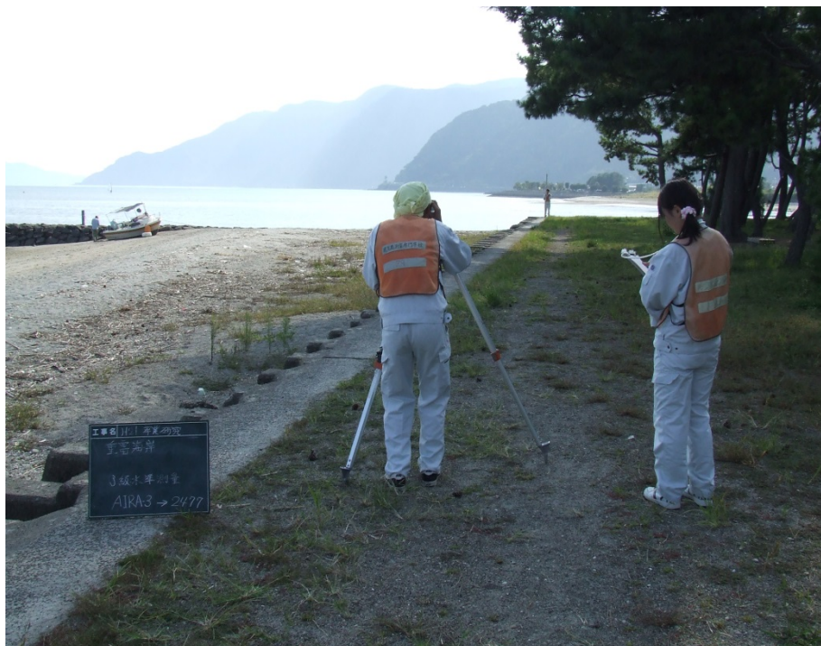
図 3-3 1 級級基準点 GPS スタティック測量（上写真）と 3 級水準測量（下写真）による水準点設置状況
