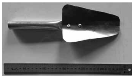
図1 移植ごて (接合はさじ部端から20mm 間隔)
