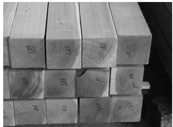
写真7 高年齢良質材から割柱を製材
