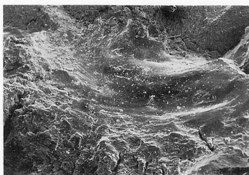
d) 最終破断域
