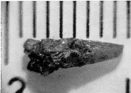
図2  $\text{I}_2$  を輸送媒体とする化学輸送反応法で育成した ZnSe 結晶
