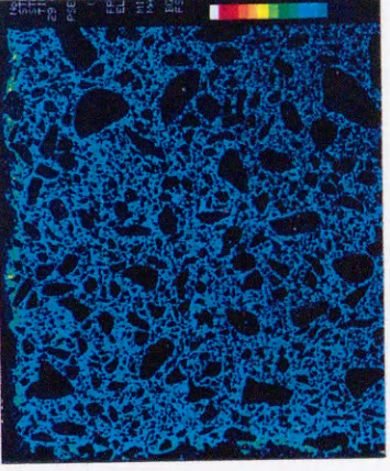
(c) pH3.0酸性雨溶液散布・ 初期中性化無・W/C50%
