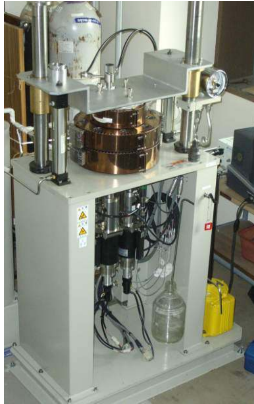
図 1 スモールパンチ試験装置の外観
