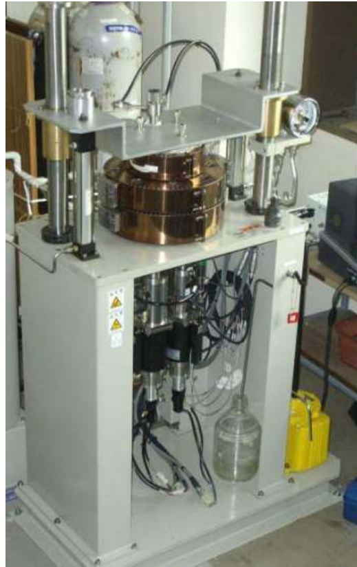
図 2 スモールパンチ試験装置の外観
