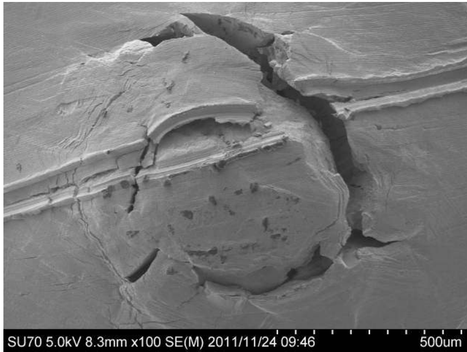
図 24 水素添加材 100 時間試験後の試験片表面観察結果
