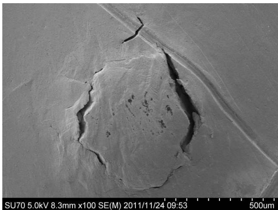
図 23 水素添加材 30 時間試験後の試験片表面観察結果
