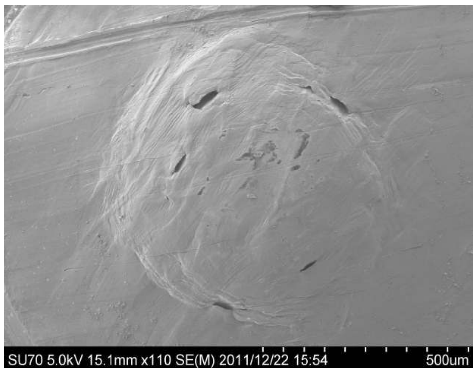
図 22 水素添加材 10 時間試験後の試験片表面観察結果
