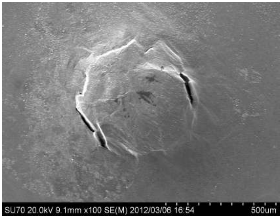
図 30 水素添加材鏡面仕上げ材 10 時間試験後の試験片表面観察結果
