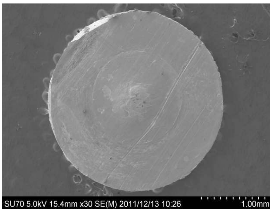
図 25 水素添加材室温大気中試験後の試験片観察結果
