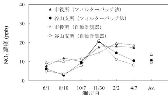
図-1 5 フィルターバッジ法と自動計測器による NO<sub>2</sub> 濃度
