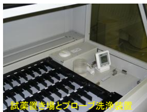
試薬置き場とプローブ洗浄装置
