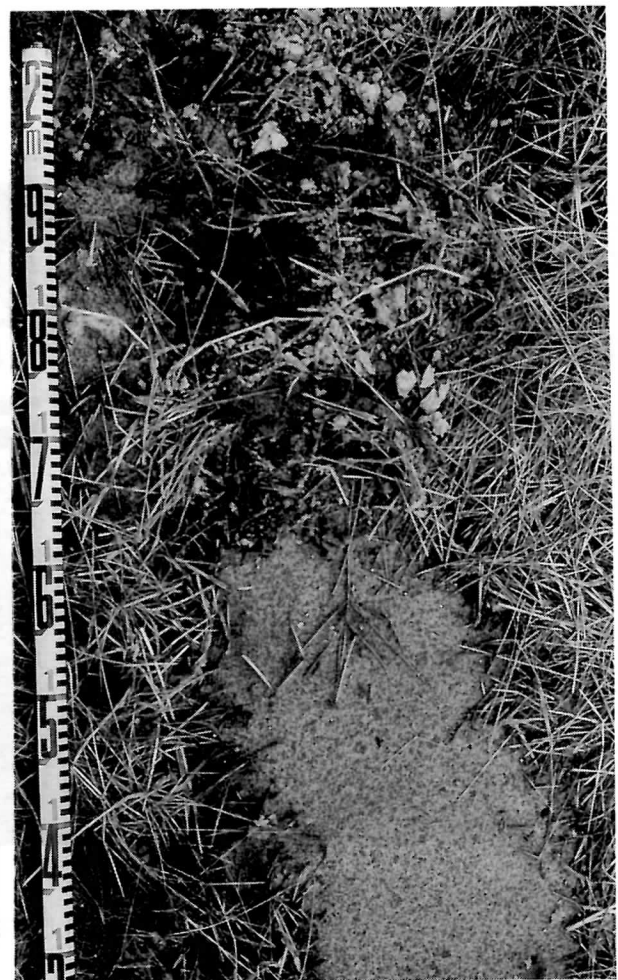
写真2. 宮之城町虎居甫立集落北方の農業用施設4ブロックにおける噴砂現象（右は噴出孔）。
