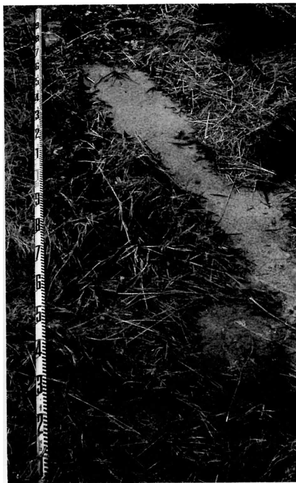
写真2. 宮之城町虎居甫立集落北方の農業用施設4ブロックにおける噴砂現象（右は噴出孔）。
