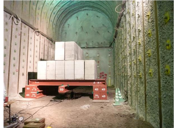
写真 5.5.3 トンネル坑内での平板載荷試験状況 (No.74 付近)
