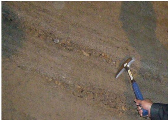
写真 4. 4. 5 新武岡トンネル切羽での二次しらす(起点側坑口) (2)
