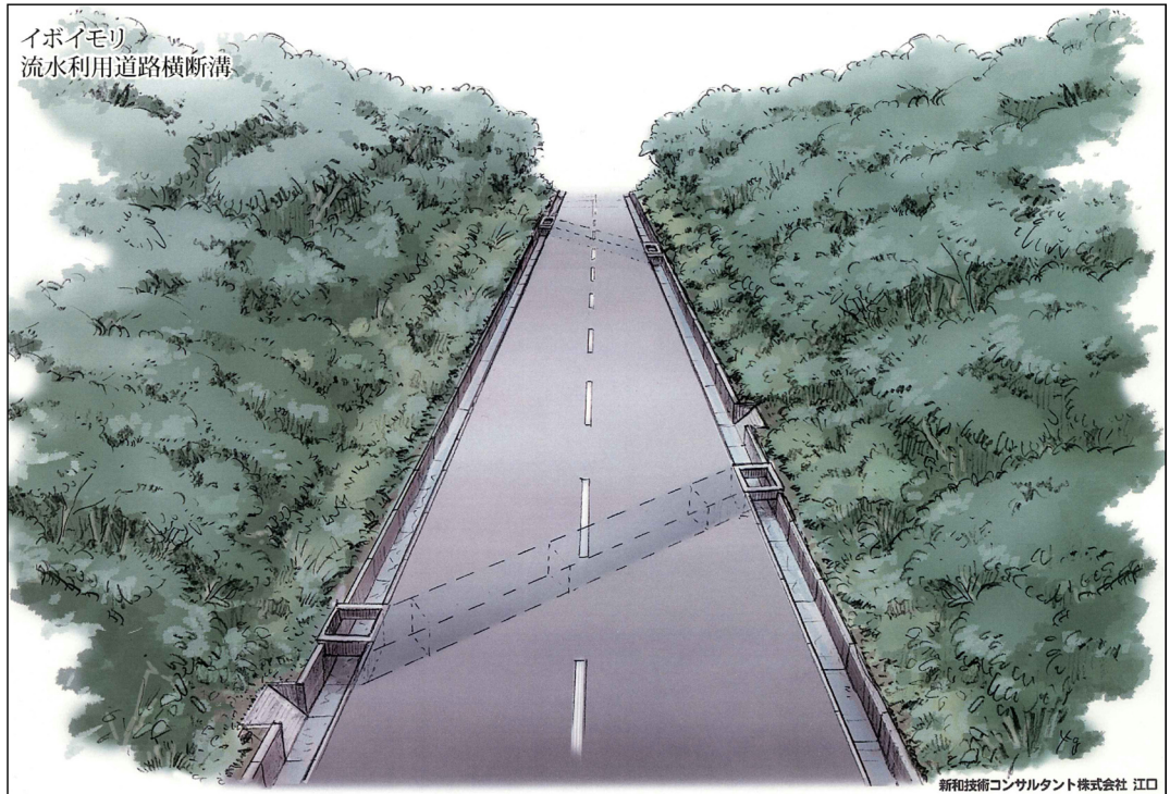
図8. ミチゲージョンを目的とした流水利用道路横断溝の構造。
