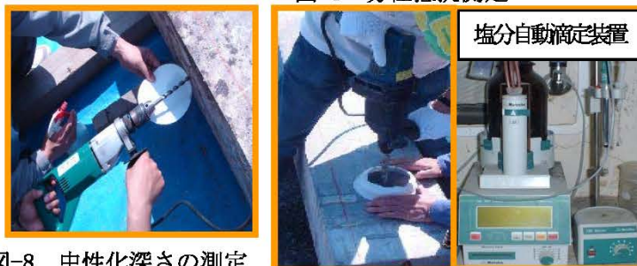
図-7 塩化物イオン濃度の分布の測定
