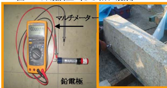
図-5 鉄筋自然電位
