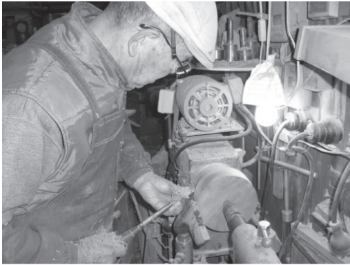
写真19 木工旋盤による輪軸製作
