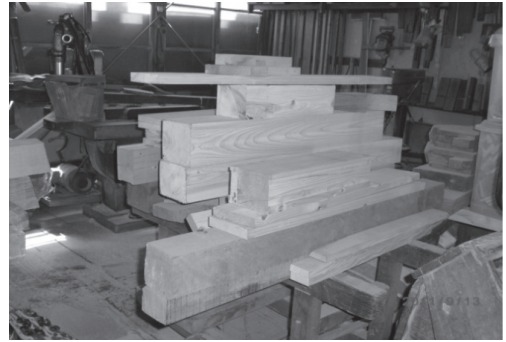
写真6 支柱用の松材
