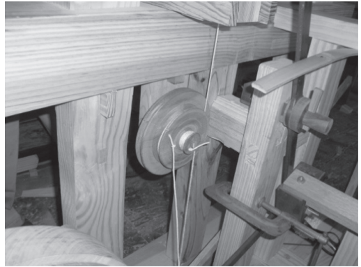
写真20 組み付けられた増速用輪軸
