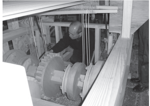
写真13 綜統機構の調整
