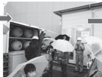
バイオマスセンターを訪問。精製、圧縮したバイオメタンガスをトレーラに充填中。
