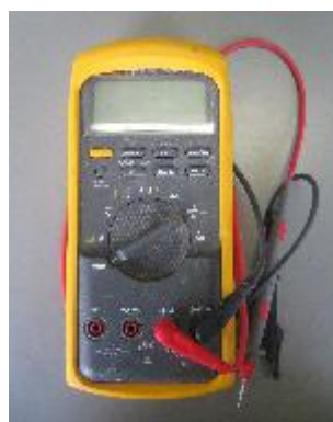
写真 6.4 自然電位測定機器
