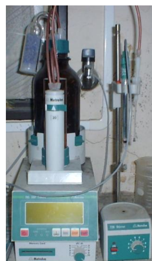
写真 6.5 全塩化物イオン滴定装置
