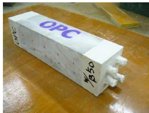
写真 6.3 鉄筋入り角柱供試体
