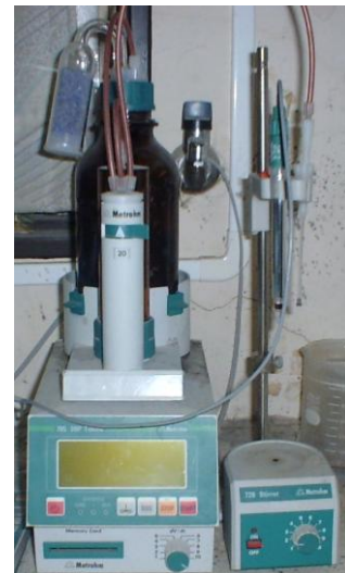
写真 5.2 全塩化物イオン滴定装置
