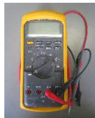
写真 5.1 自然電位測定機器
