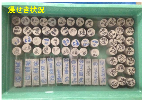
写真 7.1 硫酸塩浸せき状況
