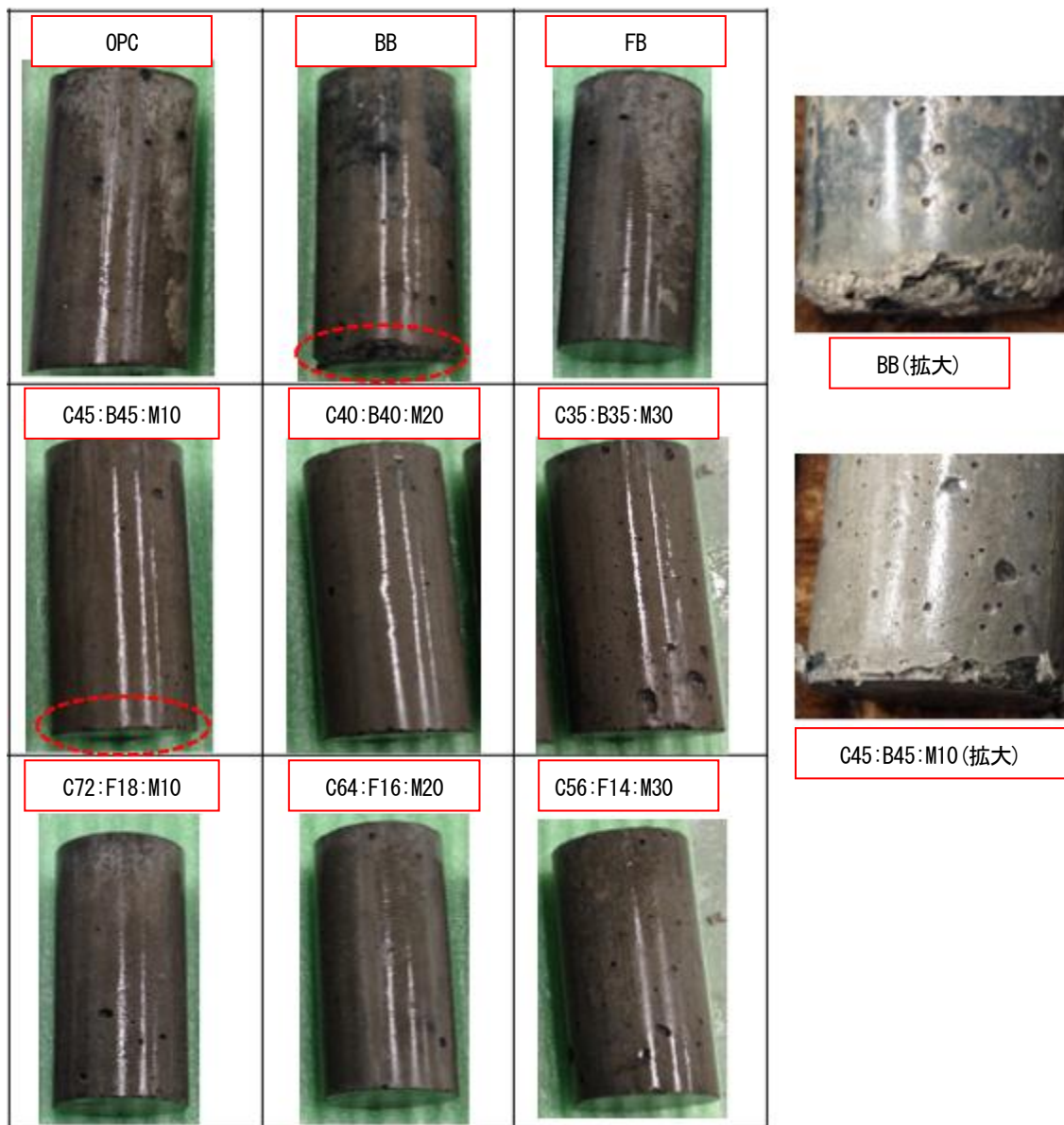
写真 7.2 浸せき 150 日経過後の供試体外観
