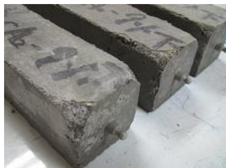
CA2-9%（水中養生7日） 写真-6.1 表面劣化状況の拡大 写真（浸漬28日目）
