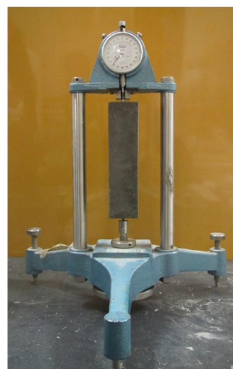
写真-6.1 長さ変化率 測定状況
