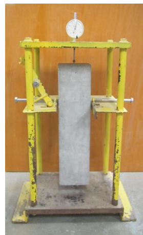
写真-3.2 乾燥収縮ひずみ 測定状況
