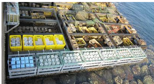
写真－4.1 海洋暴露試験状況（干満帯）
