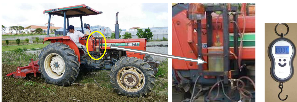
(a)補助タンク装備のトラクタ (b)補助タンク (c)電子吊秤
