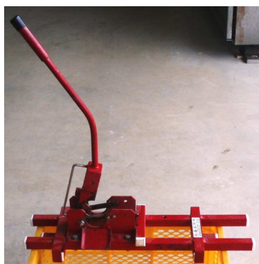
図 6-1 一芽苗切断器 切断長は 50mm または 70mm 幅:200mm, 長さ:600mm, 高さ:150mm (格納時), 重さ:5kg
