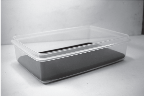
黒色の軟スポンジ板をプラスチック製タッパーに接着したもの
