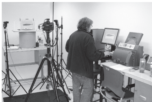
スミソニアン自然史博物館 Museum Support Center の標本撮影室。タイプ標本を横から撮影しているところ。カメラは三脚で固定され、照明はストロボを使用。撮影された画像は直接パソコンに取り込まれる
