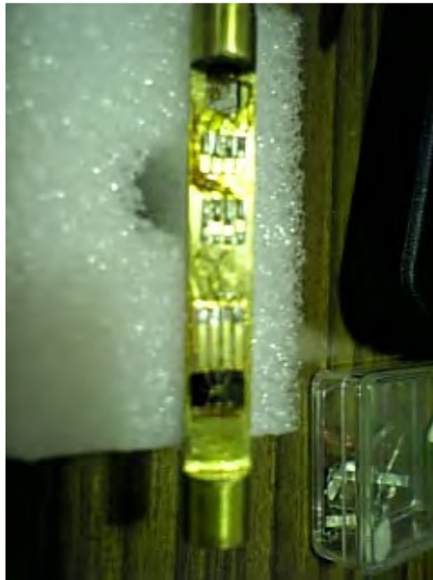
図 3.12 電気抵抗測定用のプローブ先端写真
