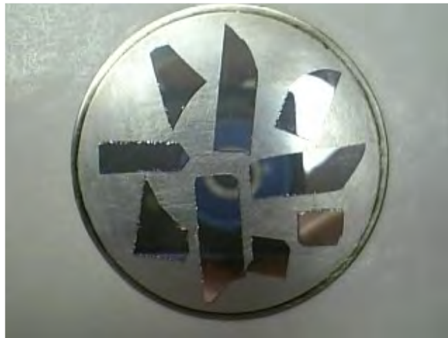
図 2.4 前駆体薄膜蒸着直後の蒸着ステージ写真
