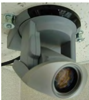
図 2.7 天井に設置したアクティブカメラ (VC-C4R)
