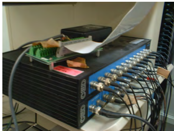
図 4.8 AD 変換装置 (CEDmicro1401)
